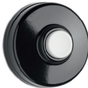
Klingeltaster Bakelit® mit weißem Taster Rundes Gehäuse aus schwarzem Bakelit mit weißem Taster (Kleinspannungstaster) mit selbstreinigendem Reibkontakt. Ø 50 mm, Höhe 20 mm. Max. 24 V~ (5 mA-1,5 A/24 VA)/max. 24 V= (5 mA-1,0 A/12 W). Bestell-Nr. 100881
