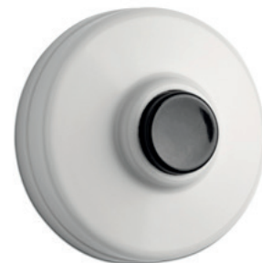
Klingeltaster Duroplast mit schwarzem Taster Rundes Gehäuse aus weißem Duroplast mit schwarzem Taster (Kleinspannungstaster) mit selbstreinigendem Reibkontakt. Ø 50 mm, Höhe 20 mm. Max. 24 V~ (5 mA-1,5 A/24 VA)/max. 24 V= (5 mA-1,0 A/12 W). Bestell-Nr. 101013
