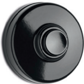
Klingeltaster Bakelit® Rundes Gehäuse aus schwarzem Bakelit mit schwarzem Taster (Kleinspannungstaster) mit selbstreinigendem Reibkontakt. Ø 50 mm, Höhe 20 mm. Max. 24 V~ (5 mA-1,5 A/24 VA)/max. 24 V= (5 mA-1,0 A/12 W). Bestell-Nr. 100880
